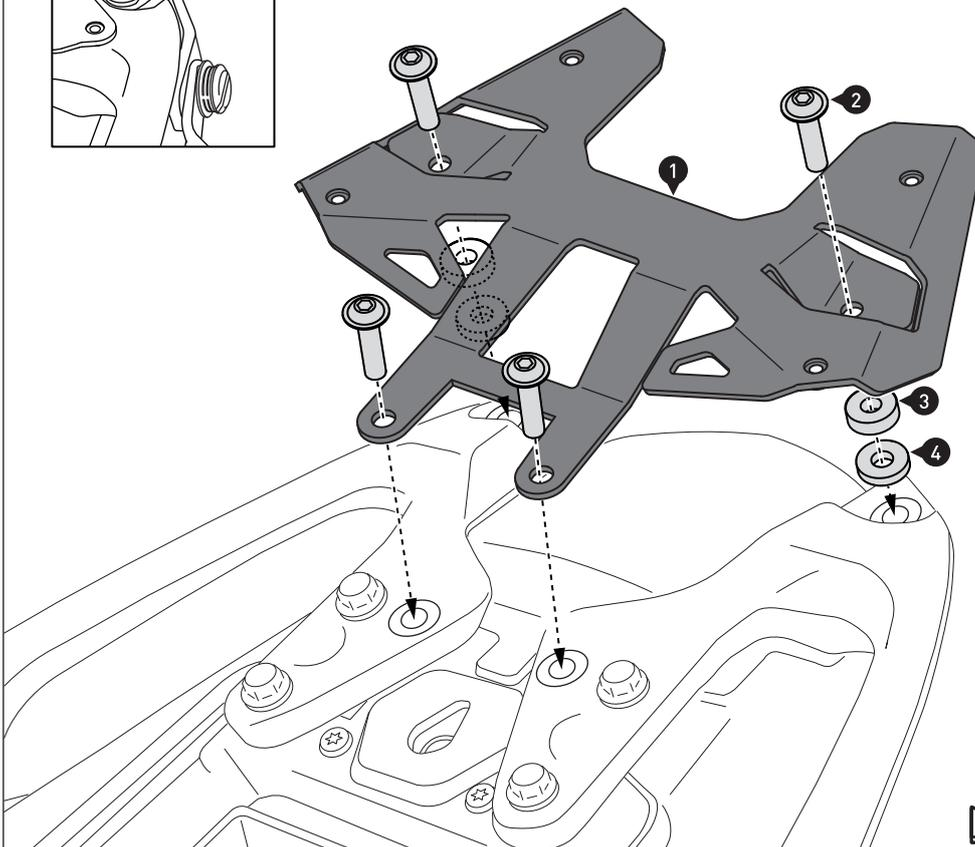
Verschrauben Sie die Unterkonstruktion (1) am Fahrzeug, wie in der Zeichnung gezeigt.
