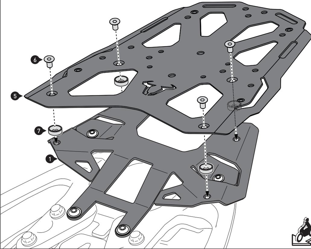
*HINWEIS:* Falls die Montage eines Adapterkit vorgesehen ist, müssen die Anbauteile am STEEL-RACK Gepäckträger vor dessen Anbau am Fahrzeug verschraubt werden.
