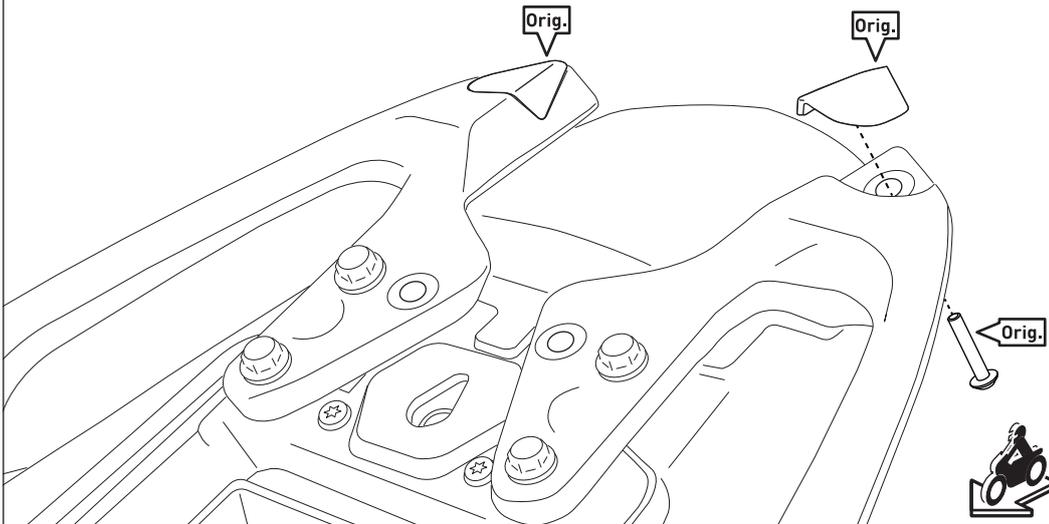
Entfernen Sie die Original-Teile und Schrauben von den Anbaupunkten.
