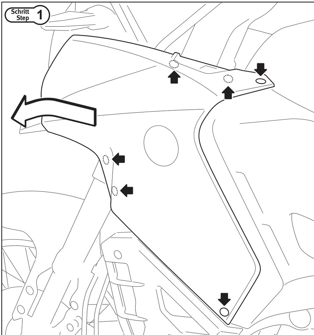
Lösen Sie beidseitig die markierte Verbindung der Verkleidungen. Drücken Sie nun die Verkleidungen in Fahrtrichtung, bis diese sich aus den vorderen Verankerungen lösen. Anschließend können die Verkleidungen vom Fahrzeug entfernt werden.
