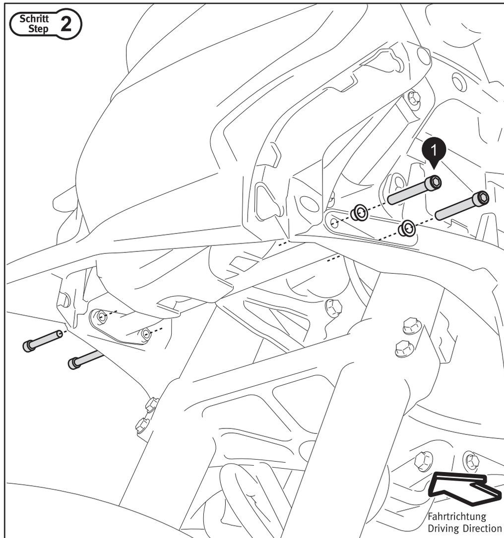
Entfernen Sie die originalen Schrauben von den Montagepunkten. Verschrauben Sie die Schrauben (1) mit den originalen Bundbuchsen wie gezeigt.
