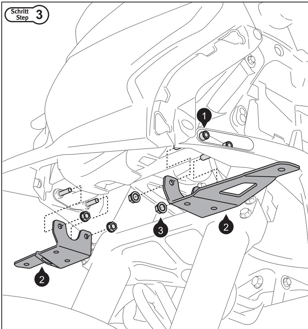
Verschrauben Sie die Anbaubleche (2) mit den Schrauben (1) am Fahrzeug.
