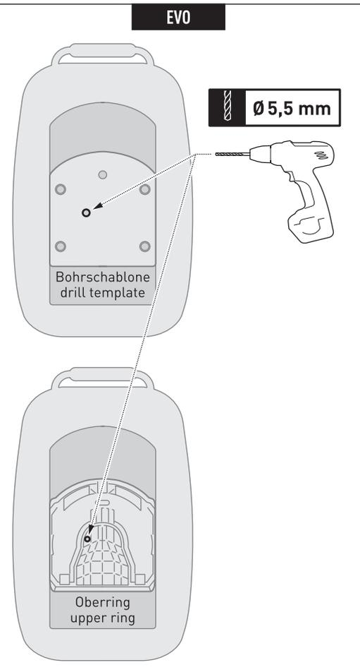
**PRO Tankrucksack:** Verwenden Sie die gezeigte Öffnung des montierten Oberrings, um mit einem 5,5-mm-Bohrer durch den Tankrucksack zu bohren. Entgraten Sie die Kanten. Verwenden Sie ein Stück Holz auf der gegenüberliegenden Seite, um das Material zu stützen.
