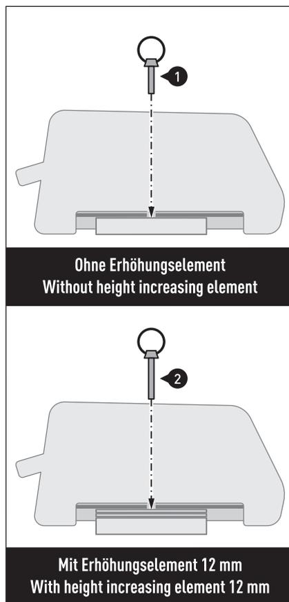
Setzen Sie den Tankrucksack auf den Tankring Ihres Fahrzeugs. Stecken den Sicherungsbolzen (1) in die zuvor gebohrte Öffnung. Dadurch wird die Mechanik des Oberrings blockiert und der Tankrucksack kann nicht mehr vom Fahrzeug entfernt werden.
